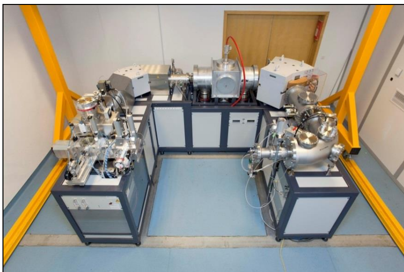
De installatie voor de ^{14}\text{C} -datering in het Koninklijk Instituut voor het Kunstpatrimonium (© KIK).
